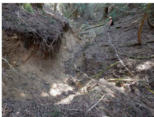
メジャーの長さは 30m、このひどい崩壊 は 70m にわたる
